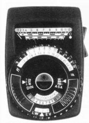
L'esposimetro separato è ideale per l'applicazione del sistema a zone. È facile adattarlo con la semplice applicazione di un pezzetto di carta su cui è riportata la scala zonale.
