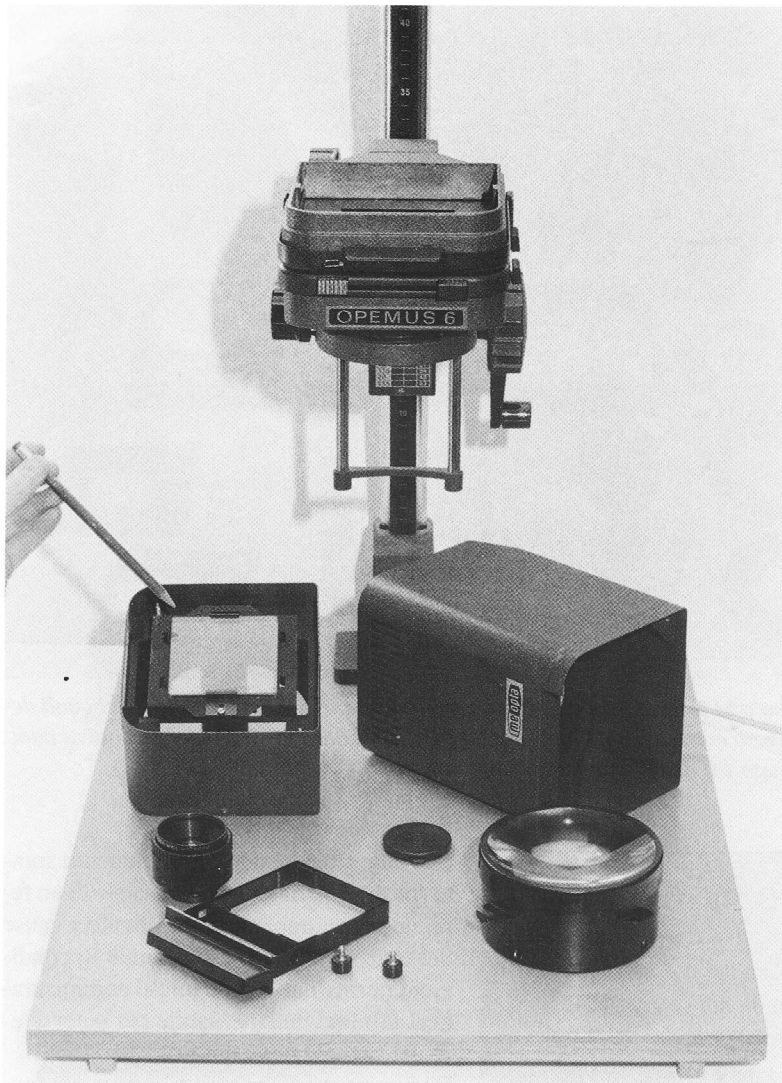
Ingranditore a luce condensata Meopta Opemus 6 con cappa illuminante, gruppo condensatori pianoconvessi e slitta portafiltro: in evidenza il filtroanticalore per separare la cappa dal sistema condensatori-portanegativi.
