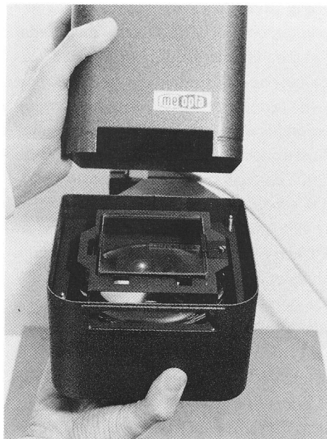
In alto la cappa illuminante dell'ingranditore Meopta e in basso il complesso filtro anticalore e condensatori.
