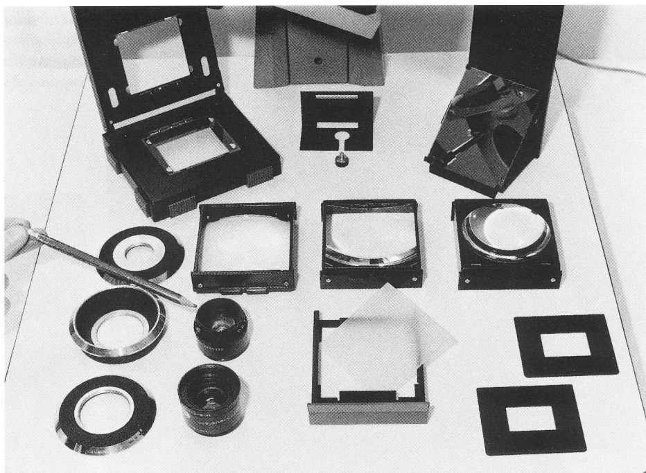
Ingranditore Durst M 601: al centro i due condensatori per il formato 120, uno dei quali deve essere impiegato con quello a lente rotonda per il formato 135; in evidenza l'ottica adatta per tale formato e il disco rientrante di montaggio.
